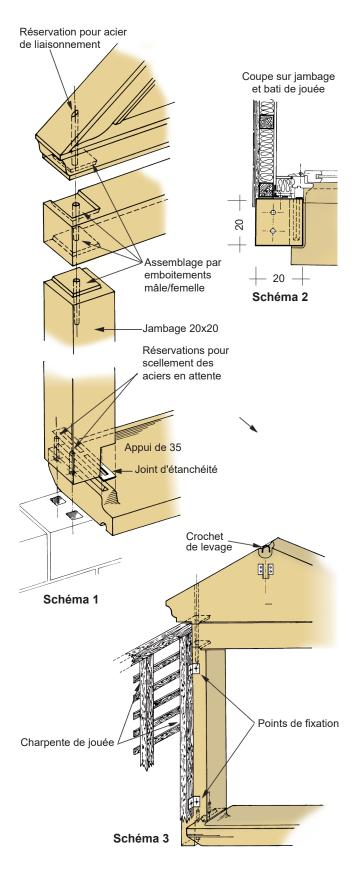
Poser d'abord l'appui sur le mur porteur ou sur une allège en maçonnerie (dans ce 2ème cas, il faudra tenir compte du poids de l'ensemble lors du calcul de charge du plancher). Remonter le mortier de pose aux extrémités de l'appui pour reprendre la charge des jambages. L'appui doit être débordant avec la goutte d'eau bien dégagée.
