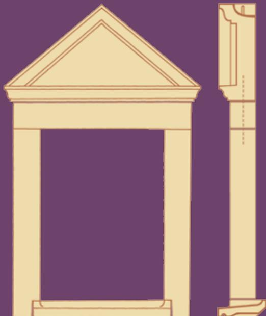
Les lucarnes à fronton sont constituées d'un élément supérieur, d'un linteau, de deux jambages et d'un appui de 35 cm.
