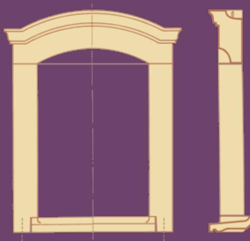
Les lucarnes chapeau de gendarme sont constituées d'un élément supérieur, de deux jambages et d'un appui de 35 cm.
